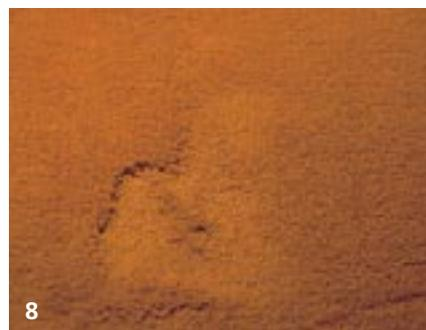
Ob zum Beispiel eine Teppichbodenqualität mit der vorhandenen veloursartigen Nutzsicht bei mechanischer Belastung ein Florscheitelungs- bzw. Shading-Phänomen zeigt, kann apparativ geprüft und untersucht werden.
